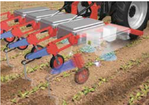
Das Projekt LUM: Vision einer Unkrautbekämpfung die Hacktechnik mit Lasertechnik kombiniert. (Foto: K.U.L.T. Kress Umweltschonende Landtechnik GmbH)
