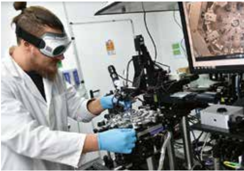
Die Fragmentierung der Linse mit einem Laser soll es zukünftig ermöglichen, deren natürliche Elastizität nach einem Lens-Refilling zu erhalten. (Foto: LZH)
