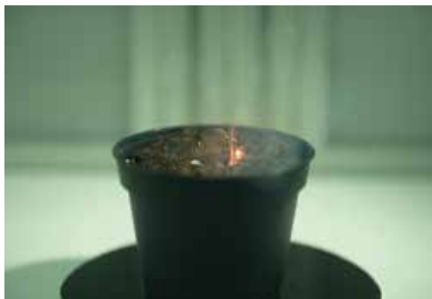
Das Wachstumsgewebe von Unkräutern kann mittels Laserstrahlung letal geschädigt werden. (Foto: LZH)
