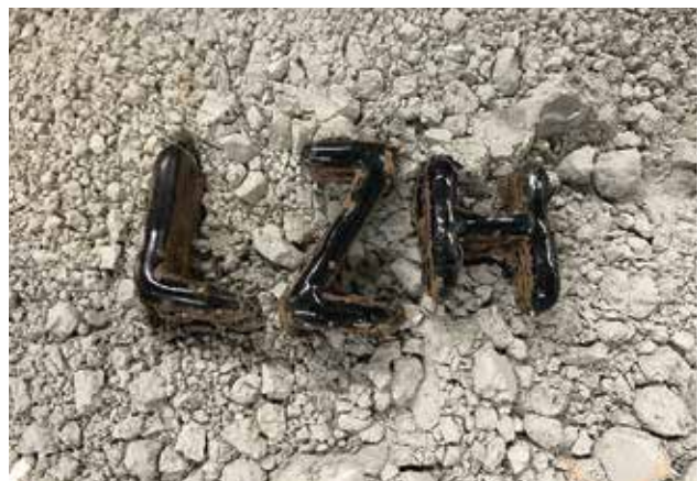
Regolith wird durch das LPBF-Verfahren zu einem glasartigen Material aufgeschmolzen. (Foto: LZH)
