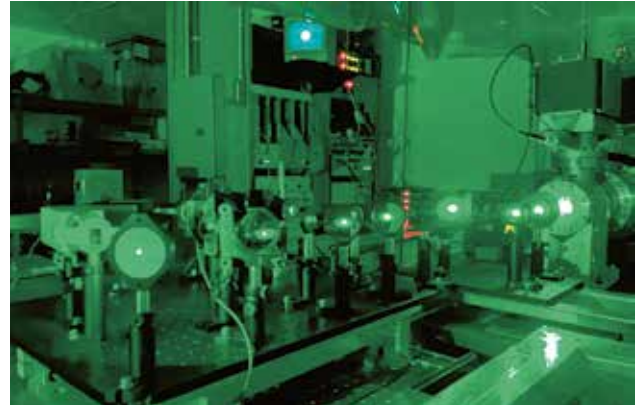
Dieser FE-Laser des Triangle University Nuclear Laboratory konnte mit LZH-Optiken erstmalig erfolgreich Wellenlängen unterhalb von 170 Nanometer erzeugen. (Foto: Triangle University Nuclear Laboratory)
