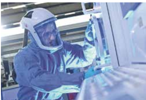
Empfehlung: Bei Wartungsarbeiten an Pulverbettanlagen sollten Beschäftigte geeignete Schutzkleidung tragen. (Foto: LZH)
