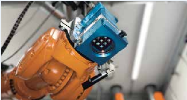
Dieser neuartige Schweißkopf macht großflächige Anbindungen von Kunststoff an Kunststoff und Kunststoff an Metall möglich. (Foto: LZH)
