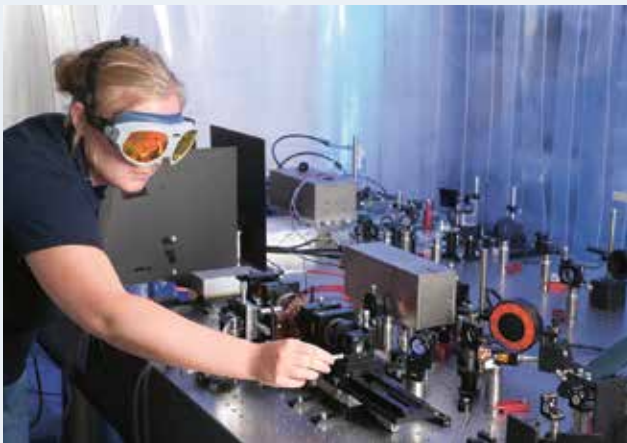
Alexandritkristalle im Test: der Laserdemonstrator im Labor. (Foto: LZH)
