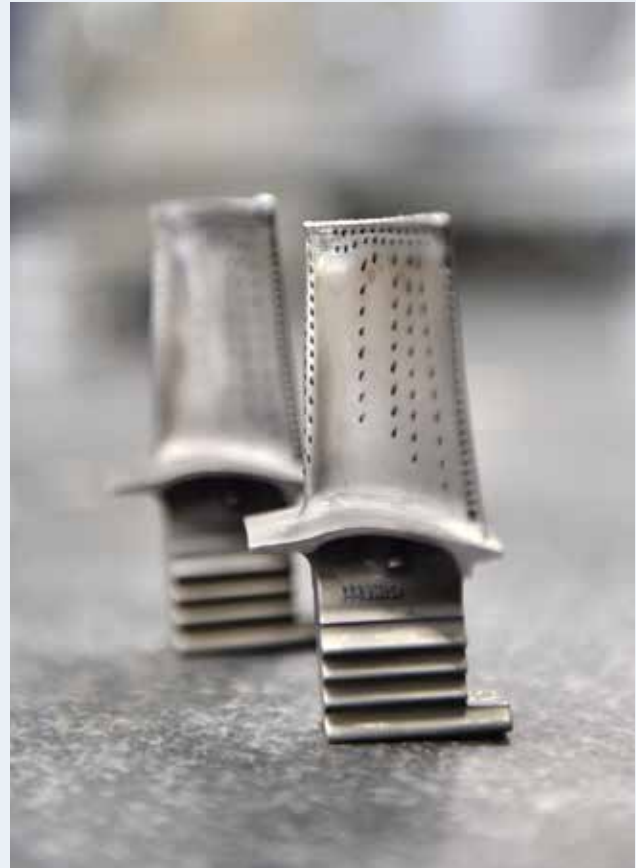
Am Beispiel von Hochdruckturbinenschaufeln forschte das LZH im Rahmen des SFB 871 zur Regeneration komplexer Investitionsgüter. (Foto: LZH)
