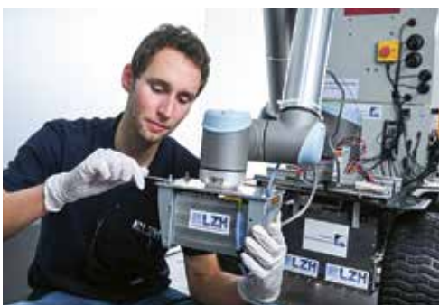
Der MOONRISE-Laser integriert am Robotorarm des Mondrovers MIRA3D des IRAS: Der Laser schmilzt erfolgreich ganze Bahnen aus Regolith auf. (Foto: LZH)
